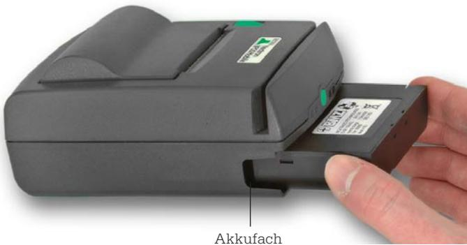
Abb. 13: Drucker - Einlegen des Akkus
